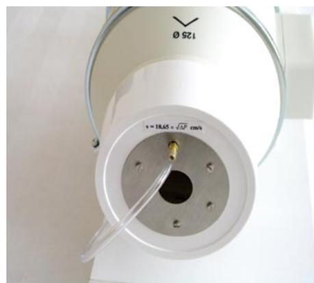
使用压差节流环进行风速校准, 校准范围分别为 0.6...1 和 1...3 m/s.
