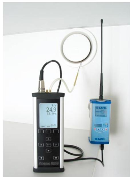
使用无线调制解调器进行远距离风平衡
