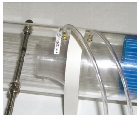
使用喷管进行风速校准, 3,0...12 m/s
