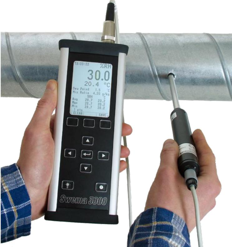
配置SWA 12的Swema 3000正在测量通风管道中的温湿度
