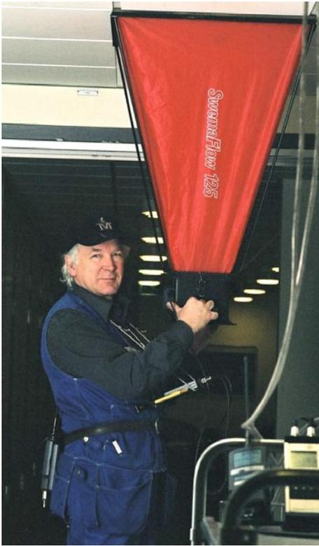
与 SwemaFlow 2000 相比较，SwemaFlow 125 拥有较小的量程和更高的精度。有用户曾经用它精确地测量过计算机散热风扇的风量！
